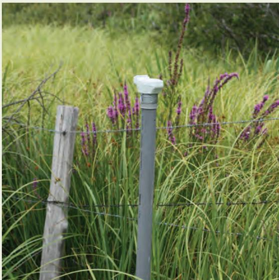
**Piézomètre équipé d'une sonde de mesure automatique**
