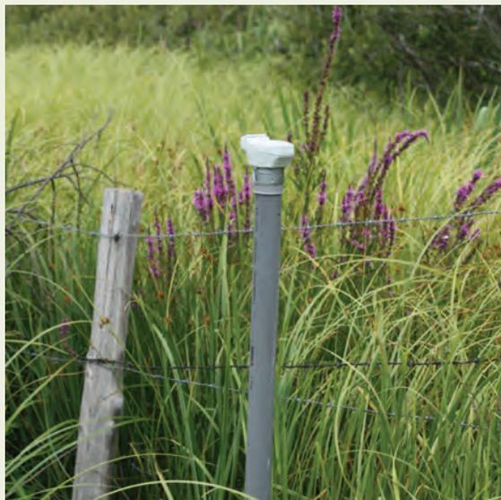
**Piézomètre équipé d'une sonde de mesure automatique**
